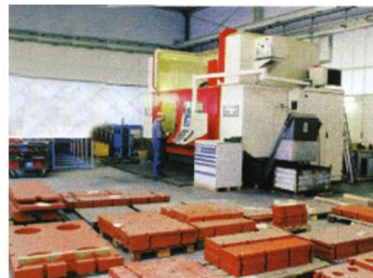
CNC加工中心/生产板式换热器框架
