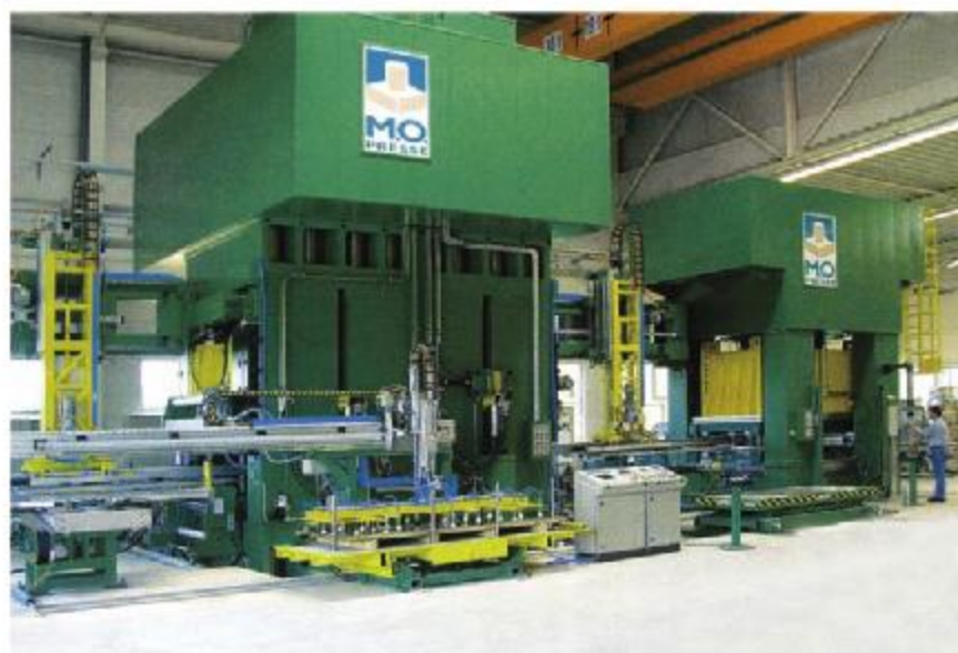
15000吨全自动板片生产线/生产大型板片，可用于复杂模具
