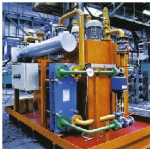
钢铁轧制行业油冷却系统
